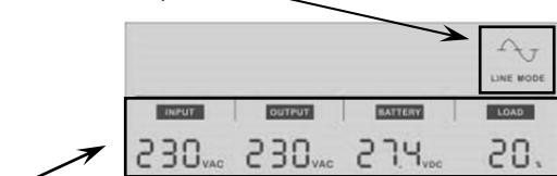
В нижней части дисплея отображаются входное (INPUT) и выходное (OUTPUT) напряжение ИБП, напряжение (заряд) аккумулятора (BATTERY) и процент использования мощности ИБП (LOAD).
