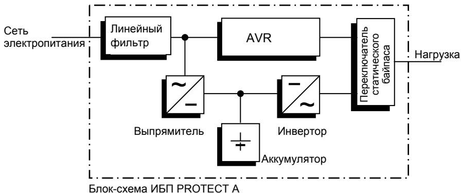
При отключении электропитания активизируется переключатель статического байпаса. При этом напряжение на подключенные устройства подается через инвертор для предотвращения потери данных или повреждения оборудования. ИБП Protect A подает напряжение, пока аккумуляторы не разрядятся или пока ИТ система не будет должным образом остановлена и отключена.
