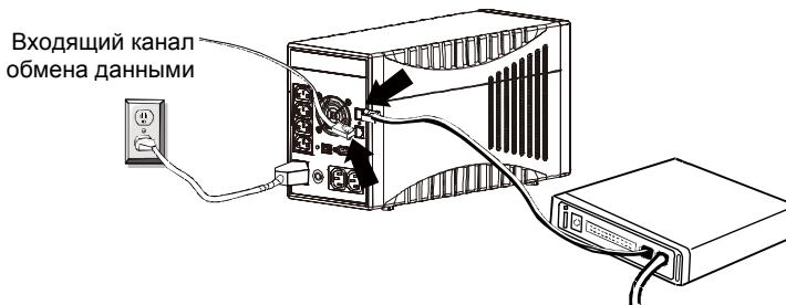
Подключите окончное устройство обмена данными (телефон, факс, модем) к разъему «OUT» (ВЫХОД).
