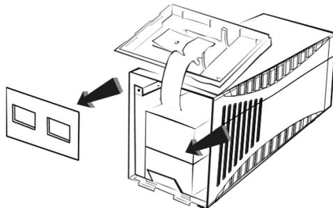
Установка выполняется в обратном порядке. **При подключении аккумулятора следите за соблюдением полярности.** (Сначала подсоедините положительный разъем, затем отрицательный. Подсоединяйте разъемы быстрым и уверенным движением!). Утилизируйте старые аккумуляторы так, чтобы не нанести ущерба окружающей среде.
