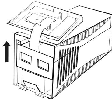
Медленно потяните на себя два аккумуляторных блока, пока не будут доступны соединительные разъемы кабеля. Сначала отсоедините отрицательный разъем, затем положительный (следите, чтобы эти разъемы не соприкасались и не касались корпуса), а затем извлеките аккумуляторы из корпуса.
