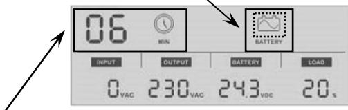
При работе от аккумулятора отображается оставшееся время работы в автономном режиме в зависимости от подключенной нагрузки. Это время отображается в минутах, и на него указывает пиктограмма «MIN» (МИН).
